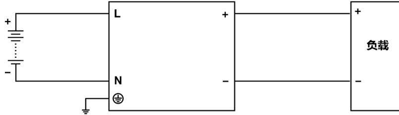
图. 4 DC 输入接线示意图
