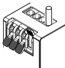
拆卸电线时, 请打开杠杆并拉出导线。
