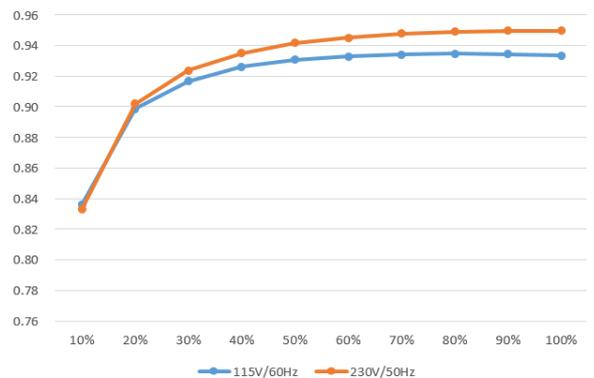
图 2. 24 V (max. 200 W) 机种典型效率曲线
