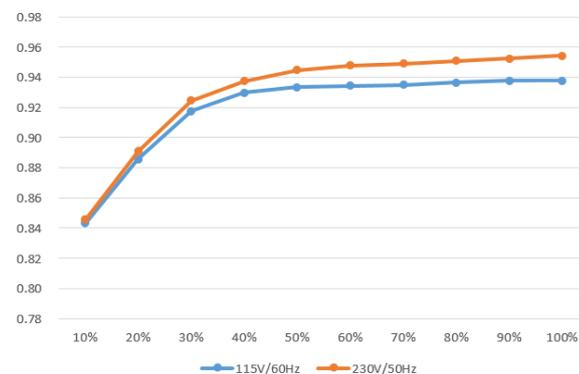
图 3. 48 V (max. 200 W) 机种典型效率曲线
