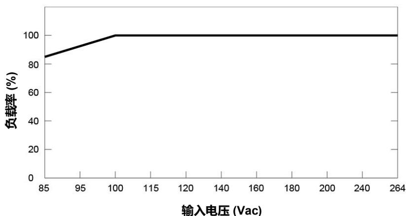
■ 输入电压 100 Vac 至 264 Vac 无输出功率降额
