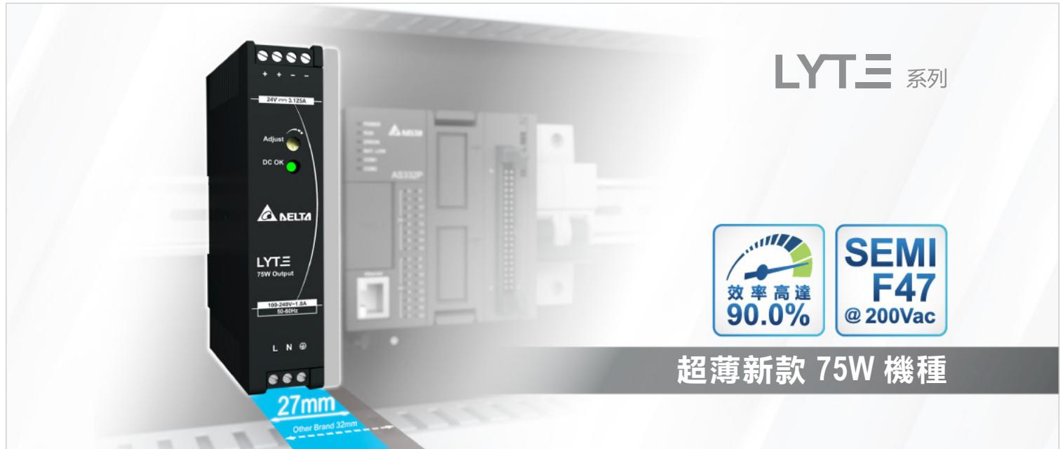
台達推出 Lyte 系列導軌型電源供應器超薄新款 75W 機種，寬度僅 27mm，為系列之最，包含 12V (DRL-12V75W1AZ)、24V (DRL-24V75W1AZ) 及 48V (DRL-48V75W1AZ) 等輸出電壓，可方便置入受空間限制的控制機櫃內。基於自然對流冷卻設計，Lyte 系列可在 -20°C 至 +70°C 溫度範圍運行。230Vac 輸入電壓下可在 -10°C 至 +50°C 全功率運行，更可於 -30°C 極低溫下啟動。得益於恆流模式的過流保護設計，使得本產品適合在電感性負載與電容性負載應用。
